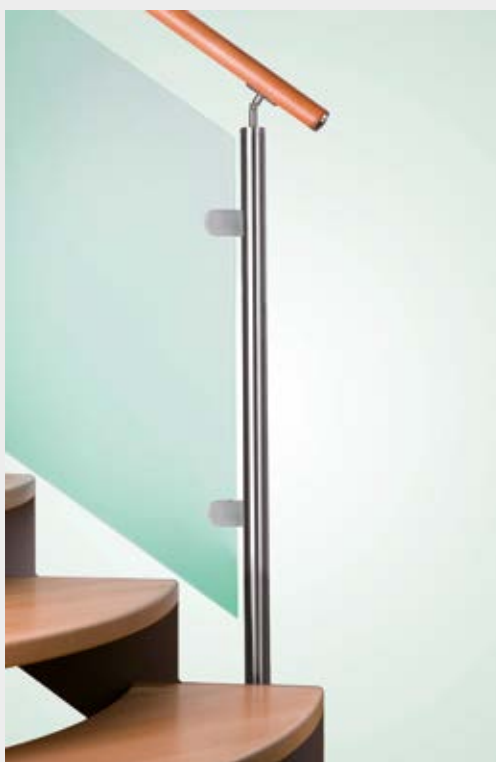
sloupek s bočním kotvením, oblý držák skla, s kaleným bezpečnostním sklem (5-5-2) float čirý, dřevěné madlo
